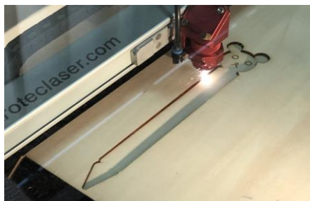
2Dデータからの加工 : レーザカッター
